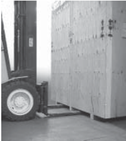
Movimentazione del quadro nell'imballo in legno. Lifting a switchboard packed in a wooden crate
